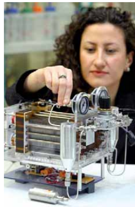
Fig. 2: Low temperature fuel cell stack demonstrator (PEMFC). Photo: Peter Förster
