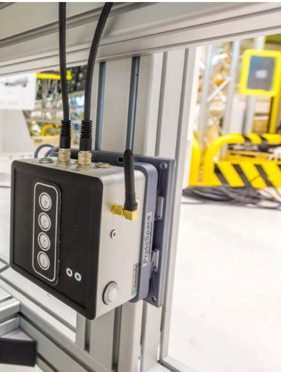
Die 600 Gramm leichte AirBOX misst 12 × 12 × 7 Zentimeter und versorgt die Logistiker bei Airbus jederzeit mit allen relevanten Informationen zum Zustand der transportierten Bauteile. Auf dem Foto rechts ist die AirBOX am Materialwagen einer Kabinentür montiert. Fotos: Airbus
