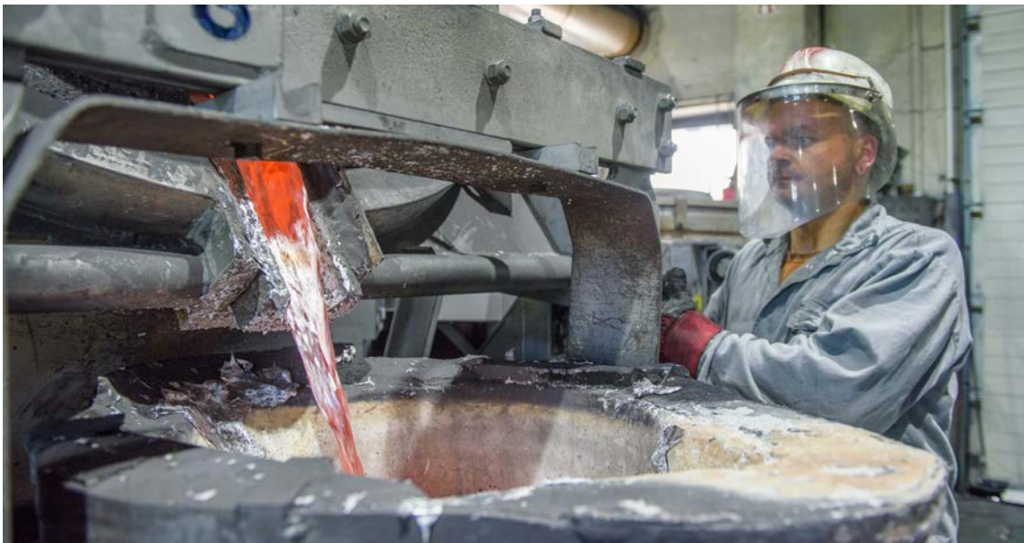
Konventionelle Prozessführung – Umfüllen des geschmolzenen Metalls. Zum Schmelzen und Beheizen wird sehr viel Energie benötigt. Foto: Leichtmetallgießerei Bad Langensalza GmbH
