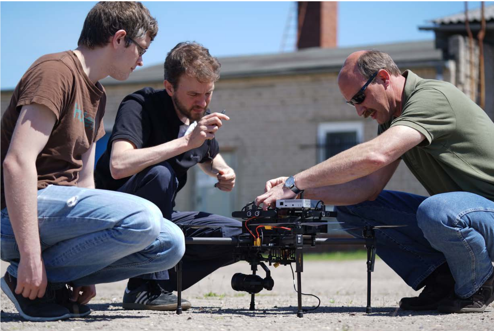
Ein risikoarmes und effizientes Inspektionsverfahren mit Multikoptern als Alternative zur manuellen Prüfung der Außenseiten von Rotorblättern an Windenergieanlagen zu finden, war das Ziel eines Forschungs- und Entwicklungsprojekts des IFF mit der GEO-METRIK-Ingenieurgesellschaft mbH Magdeburg. Foto: Christoph Walter
