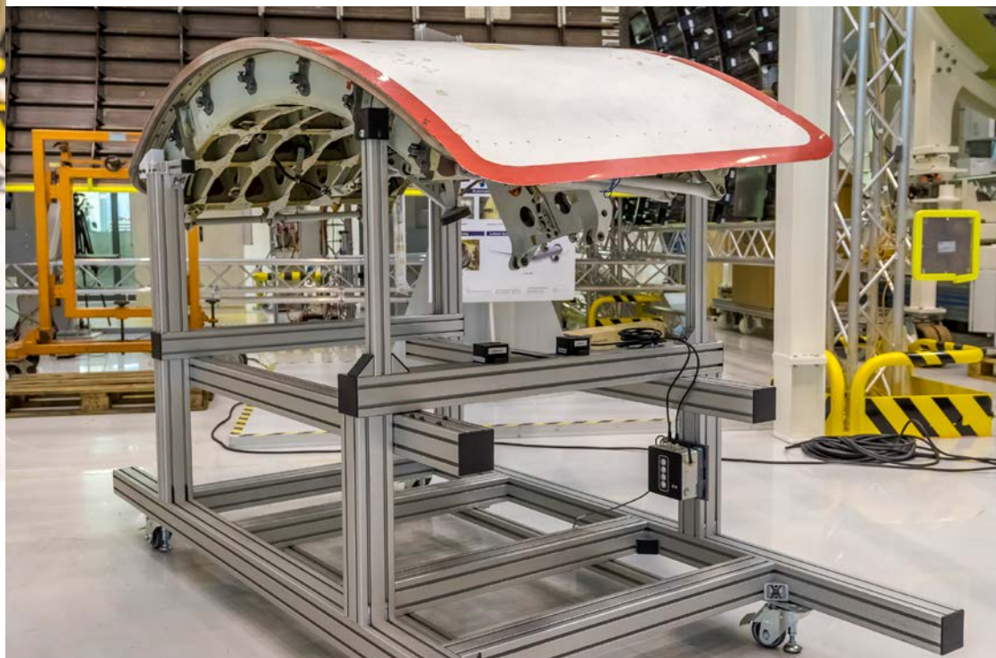
Die 600 Gramm leichte AirBOX misst 12 × 12 × 7 Zentimeter und versorgt die Logistiker bei Airbus jederzeit mit allen relevanten Informationen zum Zustand der transportierten Bauteile. Auf dem Foto rechts ist die AirBOX am Materialwagen einer Kabinentür montiert. Fotos: Airbus
