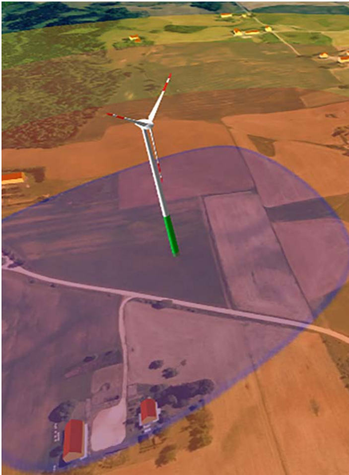
Windkraftanlage und Isophonen zur Untersuchung der Auswirkungen von Lautstärkepegeln auf die Umwelt. Bild: Fraunhofer IFF
