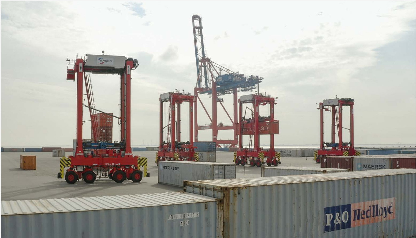
Automatisierte Straddle Carrier im Containerterminal in Wilhelmshaven – effizient und sicher. Foto: Eurogate
