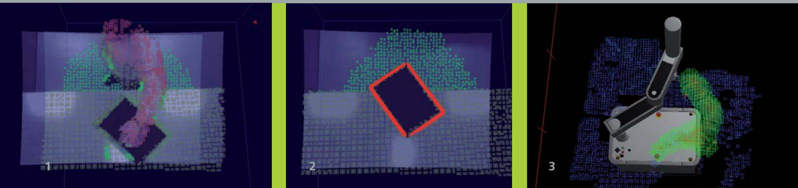
1 *Arbeitsraumerfassung mit kombiniertem Stereo/Time-of-Flight System.*
