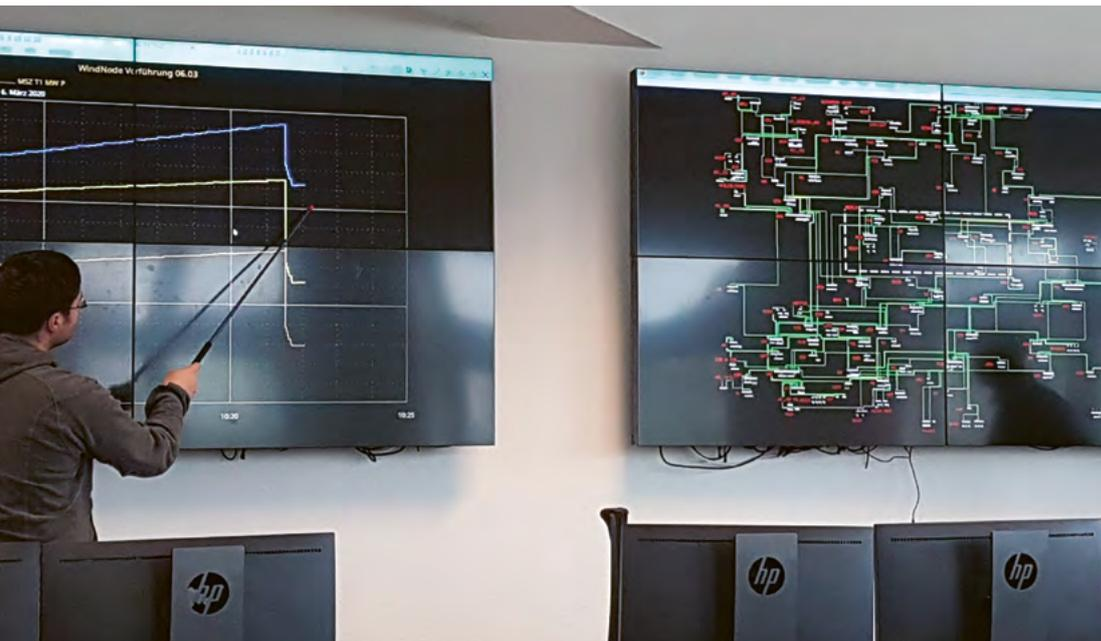
▲ Im Trainingssimulator einer Leitwarte wird beobachtet, ob und wie sich der Einsatz von Flexibilität aus den Verteilnetzen in der Regelzone auf die thermische Belastung ausgewählter Leitungen des Höchstspannungsnetzes auswirkt.
