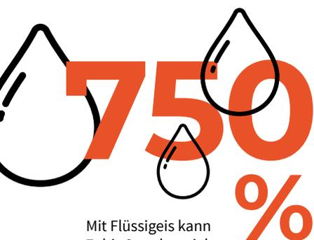
Mit Flüssigeis kann 7- bis 8-mal so viel Kälte im gleichen Volumen gespeichert werden wie mit Kaltwasser.
