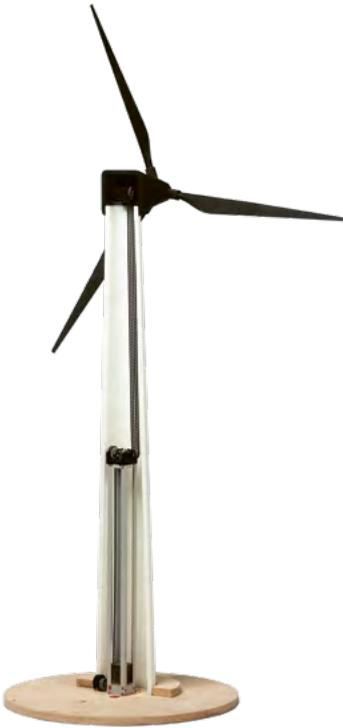
▲ Energy drop. Energie in Form eines in eine Windkraftanlage eingebauten Hubspeichers sammeln und zeitversetzt nutzen – studentische Entwurfsarbeit (TU Berlin in Zusammenarbeit mit dem Fachbereich Modell + Design).
